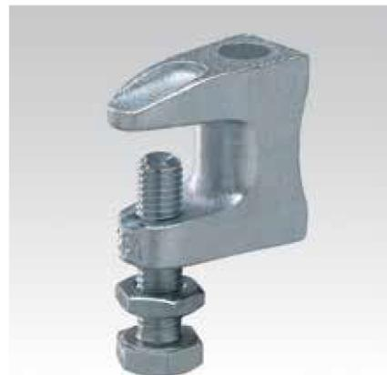
**!** Le crampon serre-joint permet des fixations rapides sur les poutres métalliques. Pour le supportage de colliers, passer une tige filetée dans le trou lisse et la bloquer par 2 écrous. A la différence avec un taraudage, il est possible de régler la hauteur, après montage, en desserrant l'écrou inférieur et en serrant l'écrou supérieur sans vissage.
